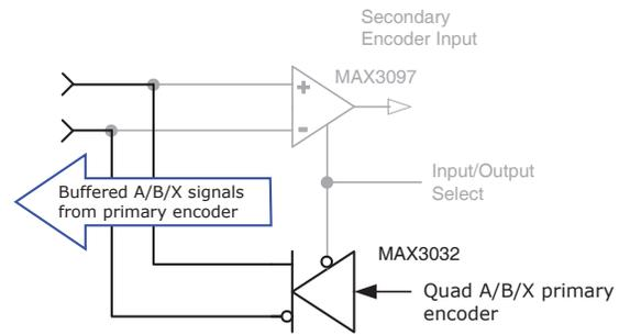
**AS EMULATED QUAD A/B/X ENCODER OUTPUTS FROM AN ANALOG SIN/COS FEEDBACK ENCODER**
