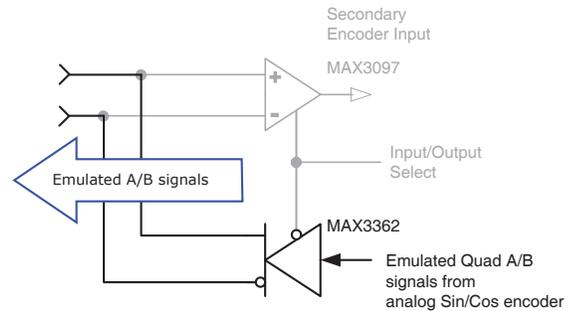
**AS A MASTER OR CAMMING ENCODER INPUT FROM A DIGITAL QUADRATURE ENCODER**
